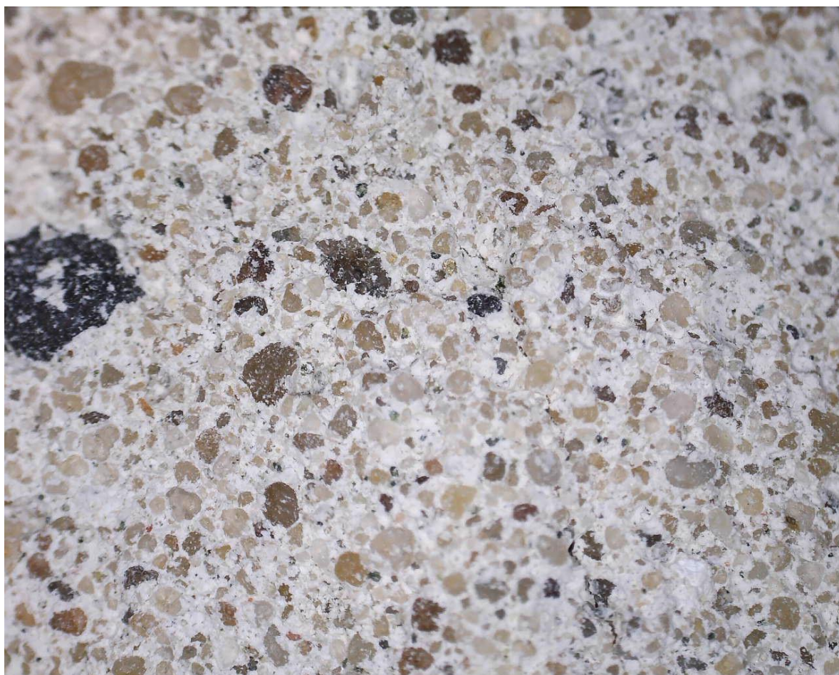
Ilustracja 9 Struktura oryginalnego tynku.
